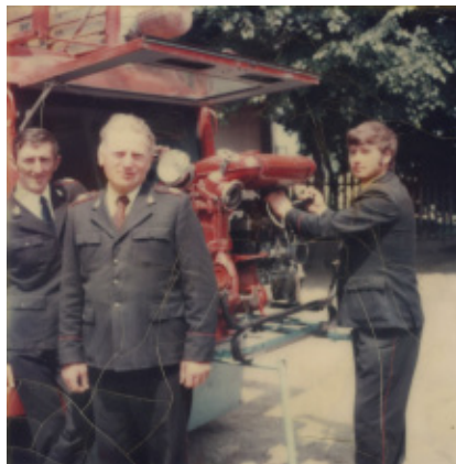
Sprawdzenie stanu technicznego motopompy M-800 umieszczonej z tyłu pojazdu
